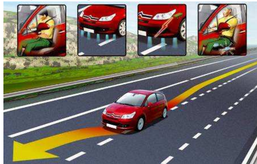
Fahrspurerkennung ohne Kamera
